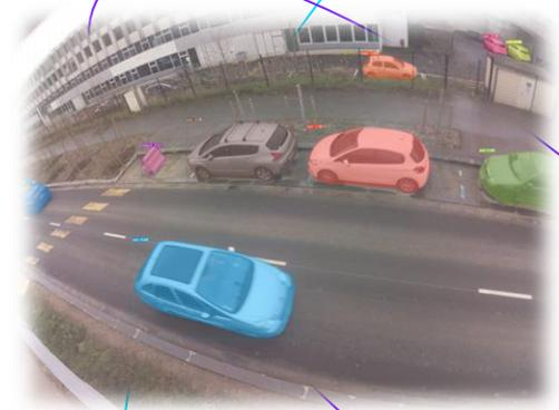
Les capteurs optiques ont la possibilité de faire du comptage entrée/sortie, que ce soit dans un parking, sur une route ou près d'un point d'intérêt.
